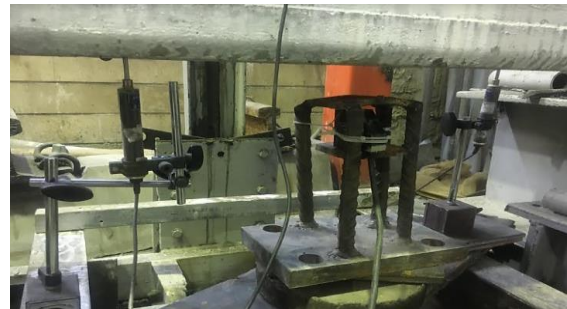
Fig. 10 Displacement measurement devices شکل 10 حس‌گرهای اندازه‌گیری تغییرمکان
