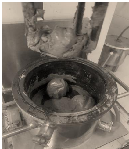
Fig. 10 Composite agglomeration at 25 °C شکل 10 آگلومره شدن کامپوزیت در دمای 25 °C
