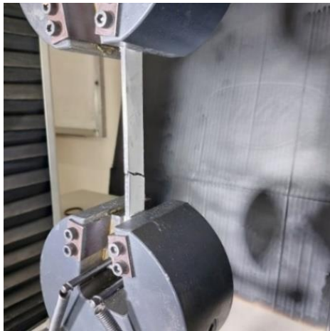
Fig. 7 Damaged sample of FML with [AL/90 3 ]s laminate in a tensile test شکل 7 نمونه گسیخته شده FML با لایه‌چینی [AL/90 3 ]s در آزمایش کشش
