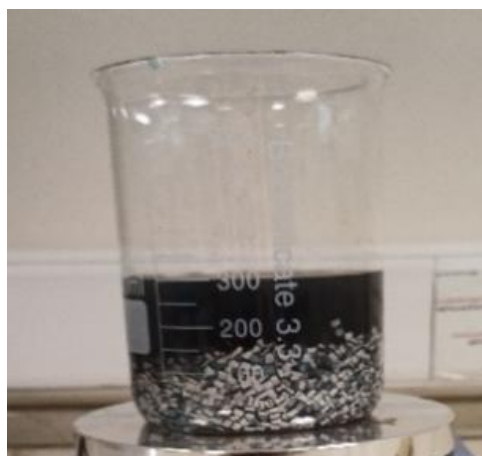
Fig. 1 Sample containing multi-walled ABS/CNT in acetone solvent شکل 1 نمونه حاوی CNT /ABS چند جداره در حلال استون
