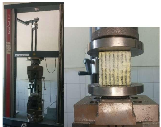
Fig. 8 Zwick- roell z100 test apparatus for quasi-static test شکل 8 دستگاه آزمون فشار و نحوه‌ی قرارگیری نمونه در دستگاه
