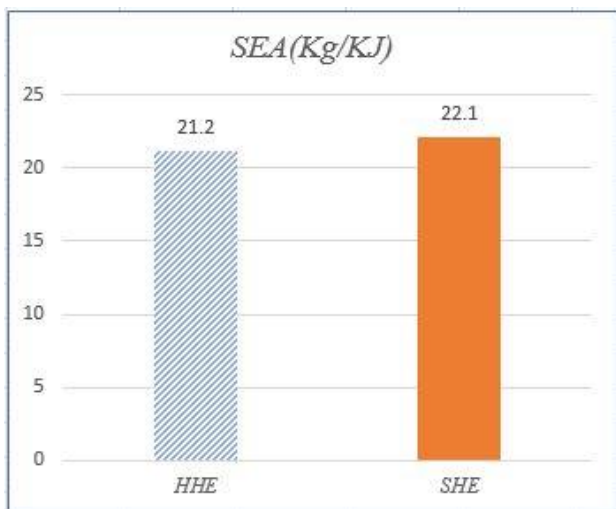
Fig. 17 Bar chart comparing the SEA of the SHE and HHE Specimens شکل 17 نمودار میله‌ای مقایسه‌ی جذب انرژی ویژه نمونه‌های SHE و HHE
