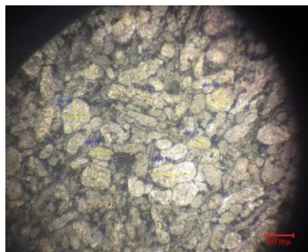
Fig. 11 Optical Microscope Image of Al 5083-8% vol C sf Sample شکل 11 تصویر میکروسکوپ نوری از نمونه‌ی Al 5083-8 % vol C sf
