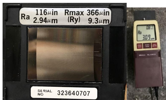
Fig. 18 Roughness meter and standard surface to calibrate the device شکل 18 دستگاه زبری سنج و سطح استاندارد جهت کالیبره کردن دستگاه.
