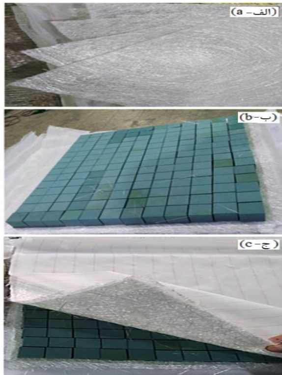
شکل 3 مراحل آماده‌سازی پیش‌فرم، (الف) لایه‌چینی لایه زیرین، (ب) قرار دادن هسته و (ج) لایه‌چینی لایه رویین
