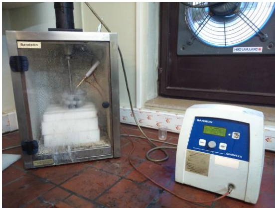
Fig. 3 Mixing of epoxy resin and MWCNTs using a sonication process شکل 3 اختلاط رزین اپوکسی و نانوذره با استفاده از فرایند سونیکیشن
