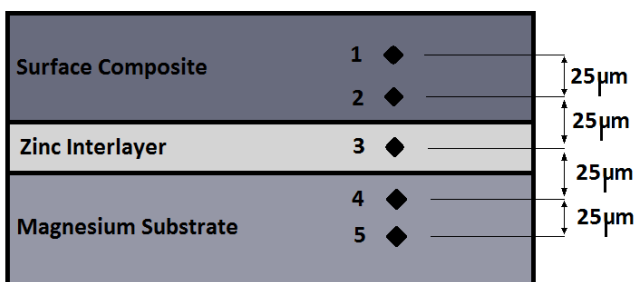
Fig. 5 Schematic of the microhardness tested points in the cross-section شکل 5 شماتیک نقاط سختی سنجی شده در سطح مقطع نمونه
