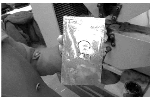
Fig. 9 Sandwich panels coated with a lubricant شکل 9 سطوح پانل ساندویچی پوشیده شده با روان‌کننده
