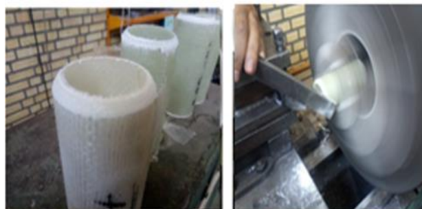
Fig. 5 chamfering with 45 degree angle at the end of samples شکل ۵ ایجاد پخ با زاویه ۴۵ درجه در انتهای نمونه
