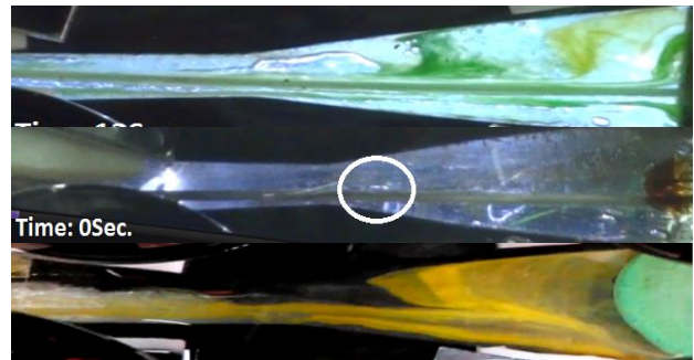
Fig. 15 View of Melt & Fiber in visualization Pultrusion Mold شکل 15 حضور مذاب و الیاف درون قالب آشکارساز پالتروژن
