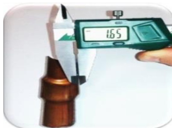
شکل ۹ اندازه‌گیری توزیع ضخامت نمونه‌های هیدروفرمینگ لوله دولایه
