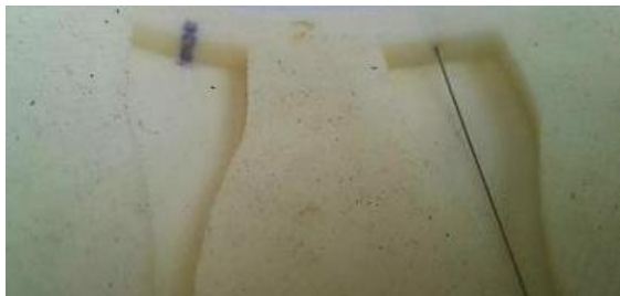
Fig. 5 The location of NiTi wire in the mold of latex samples شکل 5 موقعیت قرارگیری سیم نیتینول در قالب نمونه‌های لاتکس
