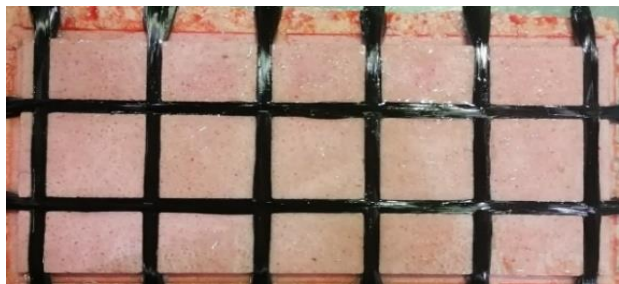
Fig. 2 Lay-up of sample grid stiffness and resin joint شکل 2 لایه‌چینی تقویت‌کننده‌های نمونه و ایجاد اتصال رزین
