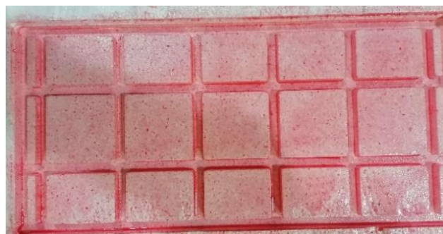
Fig. 1 Sample of grooved foam mold شکل 1 نمونه قالب فومی شیاردار
