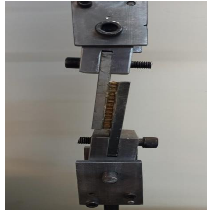
Fig. 2 Sample test of cutting a composite plate with a honeycomb core شکل 2 نمونه آزمون برش برای صفحه کامپوزیتی با هسته لانه زنبوری
