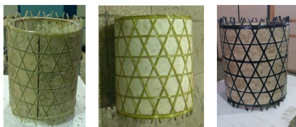
شکل 6 سازه درون قالب سیلیکونی (الف) کربن- اپوکسی، (ب) آرامید- اپوکسی و (ج) شیشه- اپوکسی
