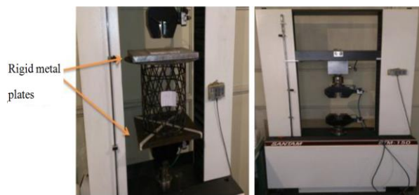
شکل 9 نمای کلی از دستگاه آزمون و آماده‌سازی شرایط آزمون
