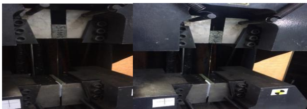
Fig. 1. Experimental test setup for pullout of SMA and steel fiber شکل 1 ستاپ آزمایشگاهی برای تست بیرون کشیدگی الیاف فولادی و SMA
