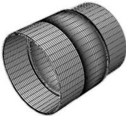
Fig. 5 Finite element mesh for the adhesive joint generated in Abaqus شکل 5 نمایش مدل اجزاء محدود ایجاد شده در محیط آباکوس از اتصال چسبی
