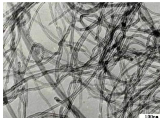
شکل ۱ تصویر میکروسکوپ الکترونی از نانولوله‌های کربنی مورد استفاده
