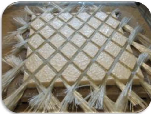
شکل ۵ پرشدن قالب از الیاف و رزین (بدون ایجاد پیش تنش اولیه در الیاف)
