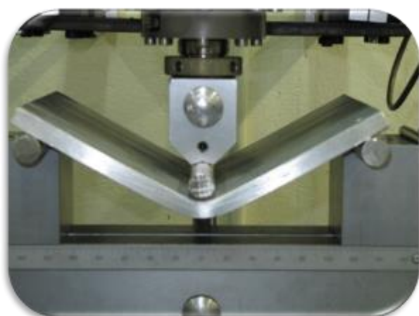
شکل ۳۳ نمونه شماره ۵ در لحظات آخر بارگذاری تست
