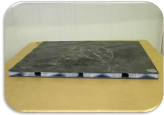
شکل ۱۴ نمونه شماره ۳ با رویه های الیاف کربن (پس از برش زوائد اضافی)
