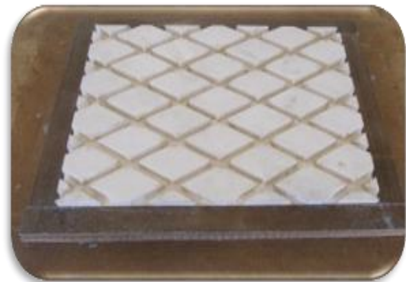
شکل ۳ قالب سیلیکونی بعد از پخت و جدا سازی
