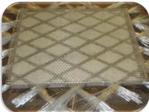
شکل ۶ چسباندن پارچه های آغشته به رزین به عنوان رویه زیرین، به روی قالب حاوی رشته‌های الیاف و رزین
