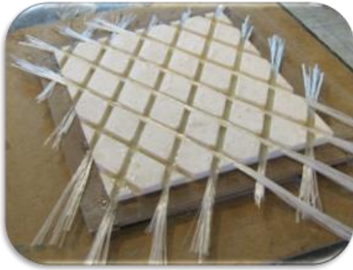
شکل ۴ خواباندن الیاف (بدون پیش تنش اولیه) و آغشته آنها کردن به رزین
