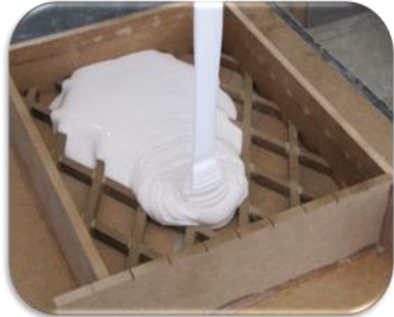
شکل ۲ ریخته‌گری سیلیکون در مدل چوبی
