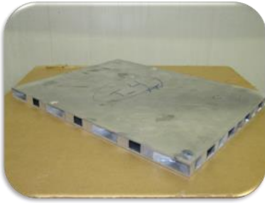
شکل ۱۷ نمونه شماره ۴ سازه ساندویچی با هسته مشبک آلومینیومی و رویه های آلومینیومی
