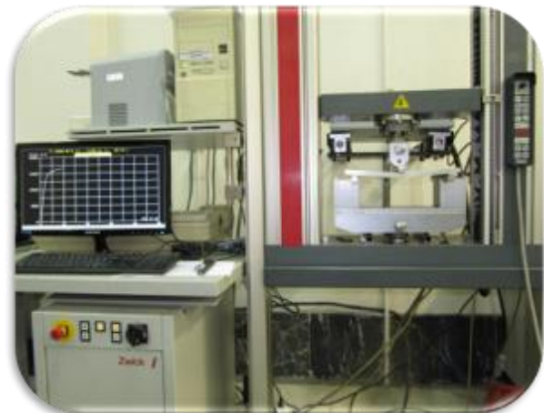
شکل ۱۹ شمای کلی تجهیزات تست Zwick / Materials Testing Z50
