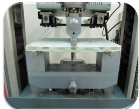
شکل ۲۰ قرار گیری نمونه اول بر روی تکیه‌گاه‌های خمش سه نقطه‌ای و بارگذاری از مرکز نمونه
