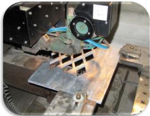
شکل ۱۵ ساخت هسته آلومینیومی با فرآیند برش سیم
