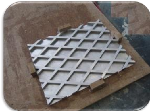
شکل ۱۶ چسباندن هسته مشبک بر رویه زیرین با چسب اپوکسی
