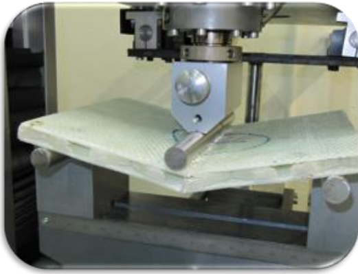
شکل ۲۱ شکست کامل نمونه شماره ۱ در لحظه پایان تست
