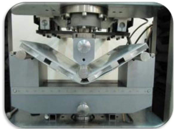
شکل ۲۹ واماندگی نمونه شماره ۴ در لحظه پایان تست
