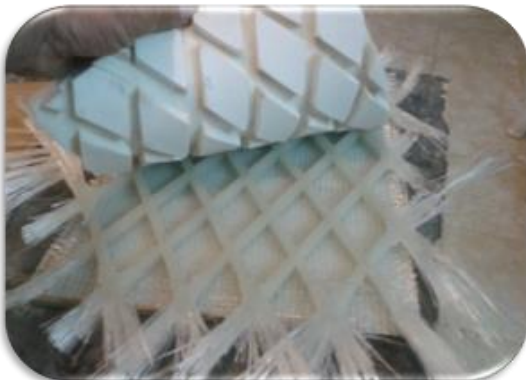
شکل ۷ جدا کردن لاستیک سیلیکون از قطعه (هسته و رویه پایین)
