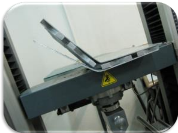
شکل ۳۱ جدایش هسته از رویه‌ها پس باربرداری (پایان تست نمونه شماره ۴)
