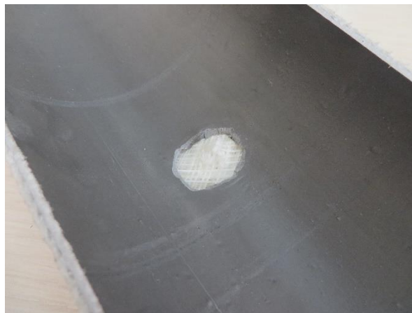
شکل ۱۲ سوراخ دایره‌ای شکل ایجاد شده بر روی لاینر
