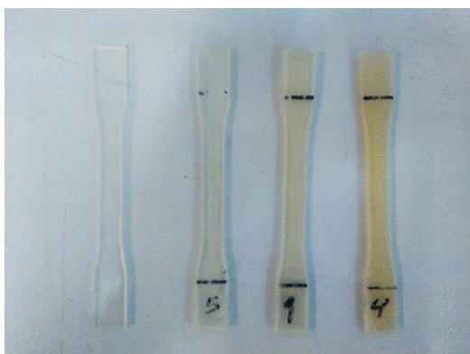
شکل ۶ نمونه‌های تست کشش از چپ به راست دارای ۰، ۰.۵، ۱.۵ و ۳ درصد ذرات نانو سیلیکا
