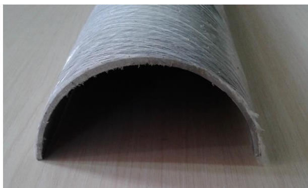
شکل ۳ لوله‌ی رشته پیچی شده دارای لاینر
