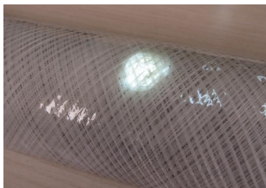
شکل ۱۰ لوله‌ی دارای لاینر روی میز نوری
