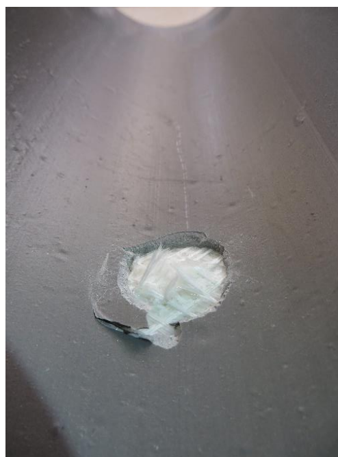
شکل ۱۴ شکست در لاینر و اتصال آن به پوسته
