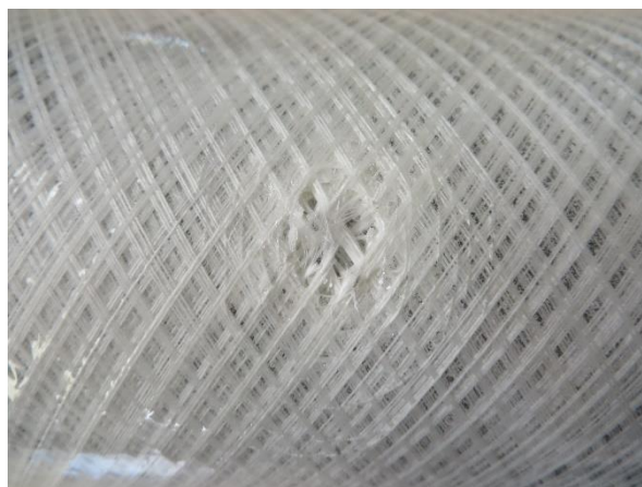
شکل ۱۱ سوراخ ایجاد شده در بخش پوسته‌ی کامپوزیت بر اثر برخورد پرتابه
