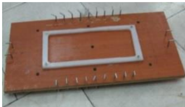
شکل ۴ قالب مخصوص ساخت نمونه‌ها
