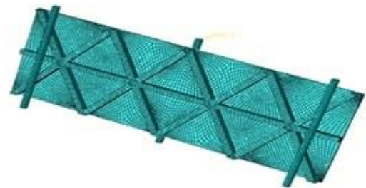
شکل ۱۰ نمونه‌ای از مش بندی انجام شده
