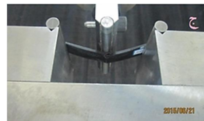
شکل ۲ مراحل انجام آزمون خمش سه نقطه‌ای، (الف) قبل، (ب) در حین و (ج) انتهای آزمون تا شکست نمونه
