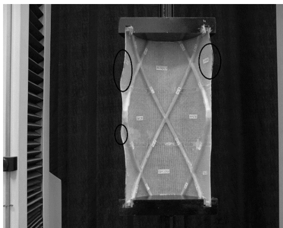
شکل ۷ رفتار کمانشی نمونه بعد از اعمال بار
