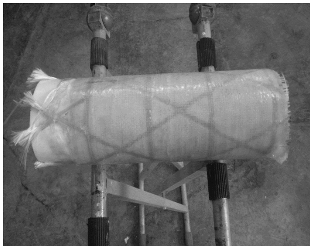
شکل ۳ نمایی از نمونه استوانه‌ای مشبک کامپوزیتی رشته پیچی شده
