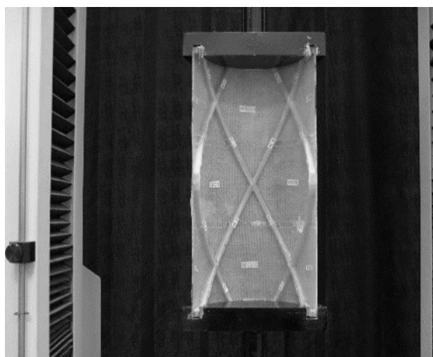
شکل ۴ نمایی از نمونه نیم استوانه‌ای مشبک کامپوزیتی در دستگاه آزمایش
