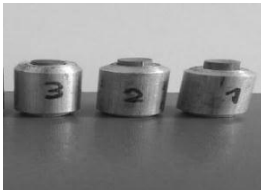
شکل ۴ نمونه‌های آماده‌سازی شده جهت انجام آزمون سایش
