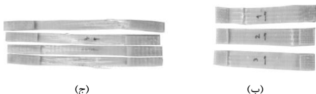
شکل ۲ (الف) نمای کلی دستگاه تست کشش (ب) نمونه‌ها پس از انجام تست کشش با الیاف 0^\circ (ج) با الیاف 90^\circ
