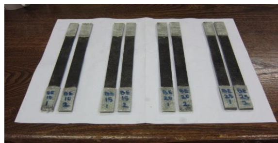
شکل ۳ نمونه‌های آزمون کشش با تب کامپوزیتی اپوکسی-الیاف شیشه در دو طرف آن جهت جلوگیری از سر خوردن نمونه از دستگاه در حین آزمون
