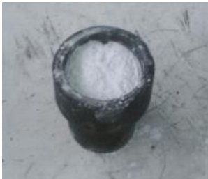
شکل ۷ ریختن پودر در قالب
