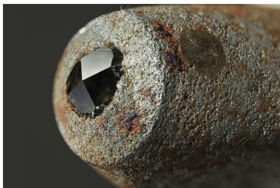
شکل ۲ ابزار فرورونده هرمی شکل الماسی آزمون ویکرز [۱۸]
