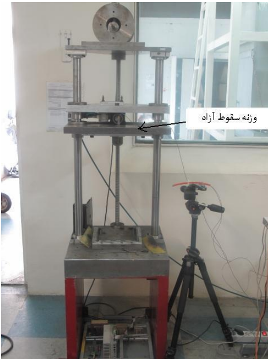
شکل ۷ دستگاه آزمایش سقوط آزاد وزنه
