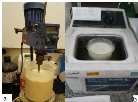
شکل ۲ مراحل جدا سازی ذرات نانو رس از یکدیگر؛ (a) همزن برقی؛ (b) دستگاه جدا کننده اولتراسونیک
