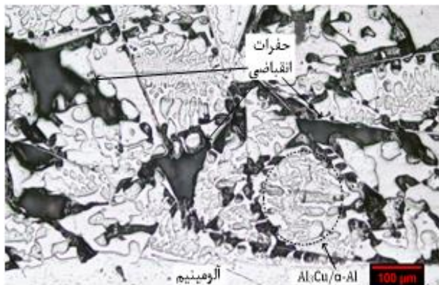
شکل ۱۱ تصویر ثبت شده با میکروسکوپ نوری از ناحیه‌ی یوتکتیک غیرعادی نمونه‌ی ۱ و تشکیل حفرات انقباضی در این ناحیه
