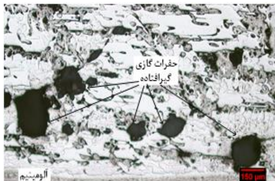
شکل ۱۰ تصویر ثبت شده با میکروسکوپ نوری از فصل مشترک مجاور آلومینیم نمونه‌ی ۴ که گویای رانده شدن حفرات گازی به سمت بخش آلومینیمی فصل مشترک است
