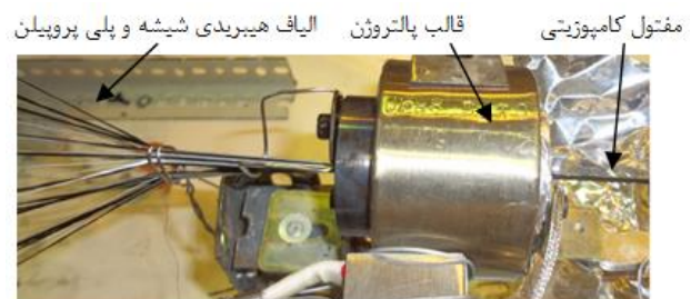
شکل ۲۰ قالب پالترژن تولید مفتول کامپوزیتی از الیاف هیبریدی
