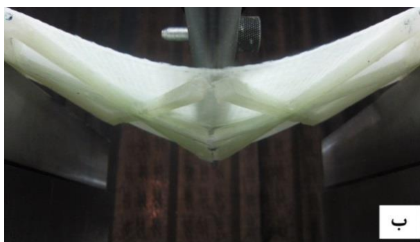
شکل ۱۱ شکست سازه مشبک کامپوزیتی، الف) شکست اولیه سازه تحت بارگذاری عرضی و ب) شکست کامل ریب افقی و جدایش دو ریب مایل از یکدیگر
