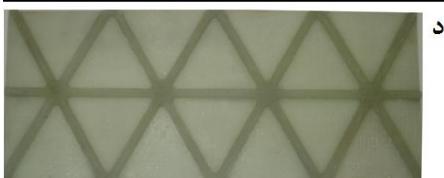
شکل ۳ مراحل اصلی ساخت نمونه‌های مشبک کامپوزیتی، الف) لایه‌گذاری ریب‌ها، ب) لایه‌گذاری پوسته، ج) پل مشبک کامپوزیتی بدون افزودن نانوسیلیکا و د) پل مشبک کامپوزیتی با افزودن نانوسیلیکا
