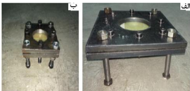
شکل ۳ فیکسچر آزمایش برش پنج نمونه‌های کامپوزیت (الف) I=۵ (ب) I=۲/۵
