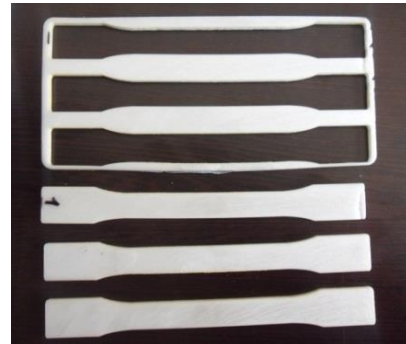
شکل ۳ نمونه‌های فوم خالص برش خورده جهت انجام تست کشش
