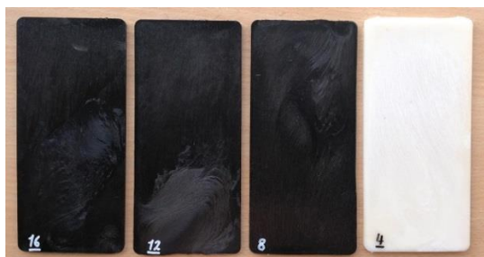
شکل ۲ نمونه‌های فوم شده در درصد‌های وزنی مختلف نانولوله کربنی
