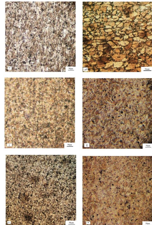
شکل ۵ تصویر میکروسکوپ نوری از منطقه اغتشاشی. (الف) فلز پایه، (ب) نمونه بدون پودر، (ج) نمونه تک پاسه، (د) نمونه دو پاسه، (ه) نمونه چهار پاسه، (و) نمونه چهار پاسه با تغییر جهت چرخش
