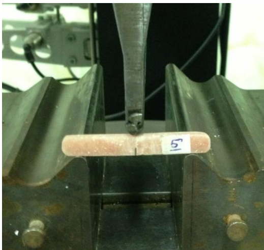
شکل ۴ بارگذاری یکی از قطعات کامپوزیتی ترک دار در داخل
