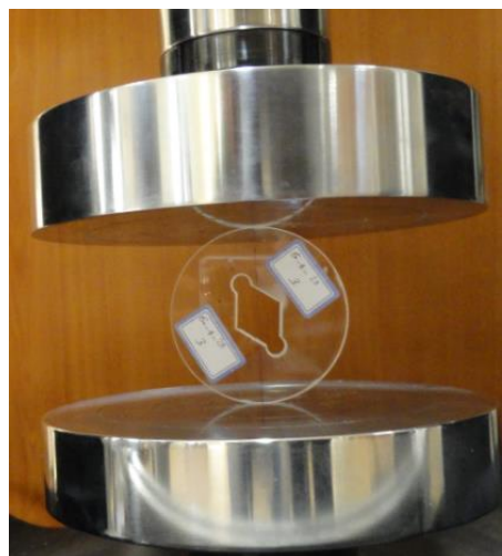
شکل ۶ نمونه آزمایشگاهی VO-BD در حین آزمایش شکست مد ترکیبی
