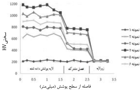
شکل ۱۰ پروفیل سختی سطح مقطع عرضی نمونه‌های پوشش داده شده
