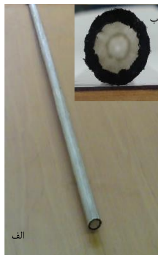
شکل ۱۴ محصول سالم تولید شده، (الف) نمای بالا (ب) نمای جانبی
