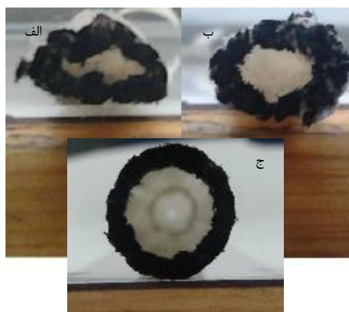
شکل ۱۵ مقایسه شکل‌ها (الف): هوای محیط، (ب): هوای محیط و دمنده و (ج): هوای محیط، دمنده و هوای فشرده
