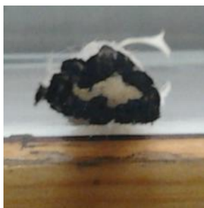
شکل ۱۳ نمایش مقطع برش خورده محصول در حالت جمع شدگی
