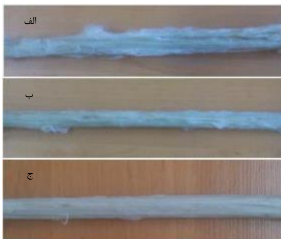
شکل ۱۲ استفاده از الف) دمنده و دمای 200^{\circ}\text{C} ، ب) دمنده، دمای 200^{\circ}\text{C} و پیش‌گرم ج) دمنده، دمای 200^{\circ}\text{C} ، پیش‌گرم و فیلم پلیمری
