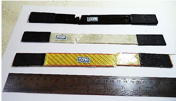
شکل ۲ نمونه های آزمون کشش با تب سمباده ای.
